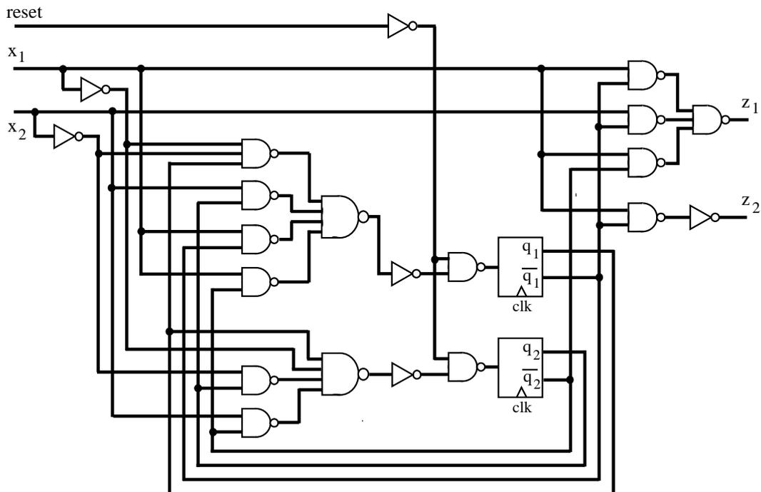
6°: 上記の回路の状態遷移回路および出力回路において、カーネル(共通項)を用いて論理ゲートの共有化を行い、多段 NAND 回路にすることにより、ゲート数を削減してみる。そのため、まず、以下の共通項を抽出する。
