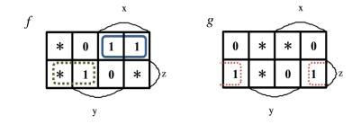
従って、1のマスを全て被覆するような最小個数の主項(ベイチ図上で少なくとも1つの1のマスを含み、0のマスを含まない AND 項)を求めると、上図に示したものが得られる。そこで、これらの主項を用いて関数 f(x,y,z) および g(x,y,z) を表すと、それぞれ次の最簡な積和形論理式を得る。
