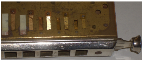
図 2.6 コンセルティーナ (Hohner 20 keys) 内部のリードケース (左) と、ハーモニカ (Hohner Chromatic-C) の高音部のリード (右)。ハーモニカのリードは、静止状態では間隙から少し浮いており、吹奏用と吸奏用では基盤の表裏反対側に取り付けられている。
