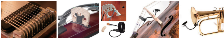
図 3.108 ピックアップの例。左から，電磁ピックアップ（ペダル・スチールギター。Paul Reed Smith 社製。Premier Guitar の HP より），ピエゾ素子（電気ヴァイオリンのコマの足と表板の間に装着。ヤマハの HP より），ピエゾ素子（Kremona North America 社製 VC-1。チェロのコマの高音側の間隙に挟み込み。KNA 社の HP より），マイクロフォン（Danish Professional Audio 社製 VO-4099。チェロ，トランペット向き。DPA 社の HP より）。
