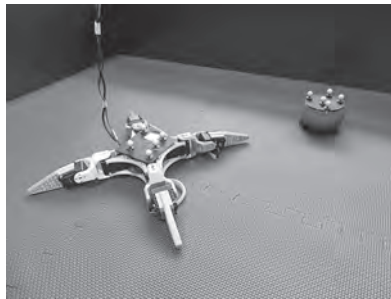
図 2 実際に構成した、ニューラルホメオスタットに基づく機械獣
