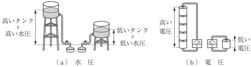
図 1.3 電圧を水圧で考える
