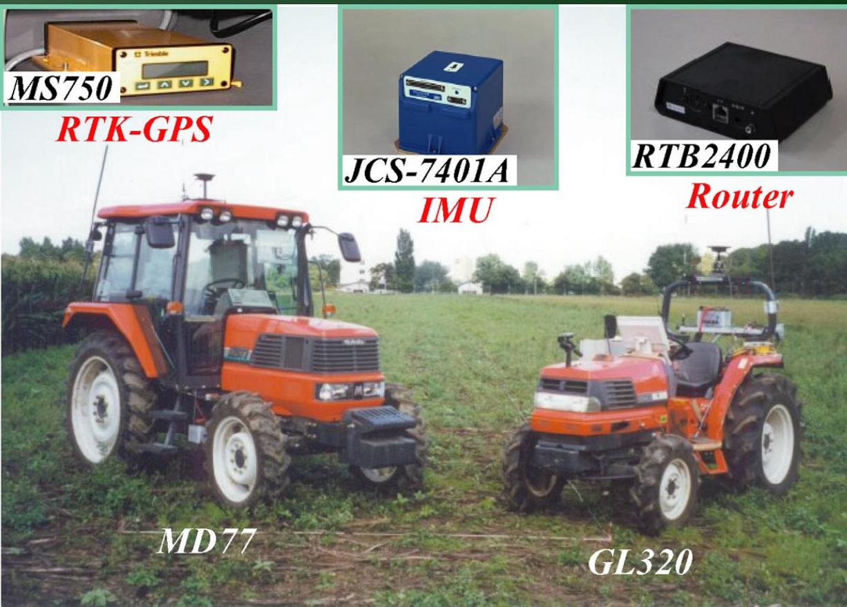
ロボットトラクタの構成
