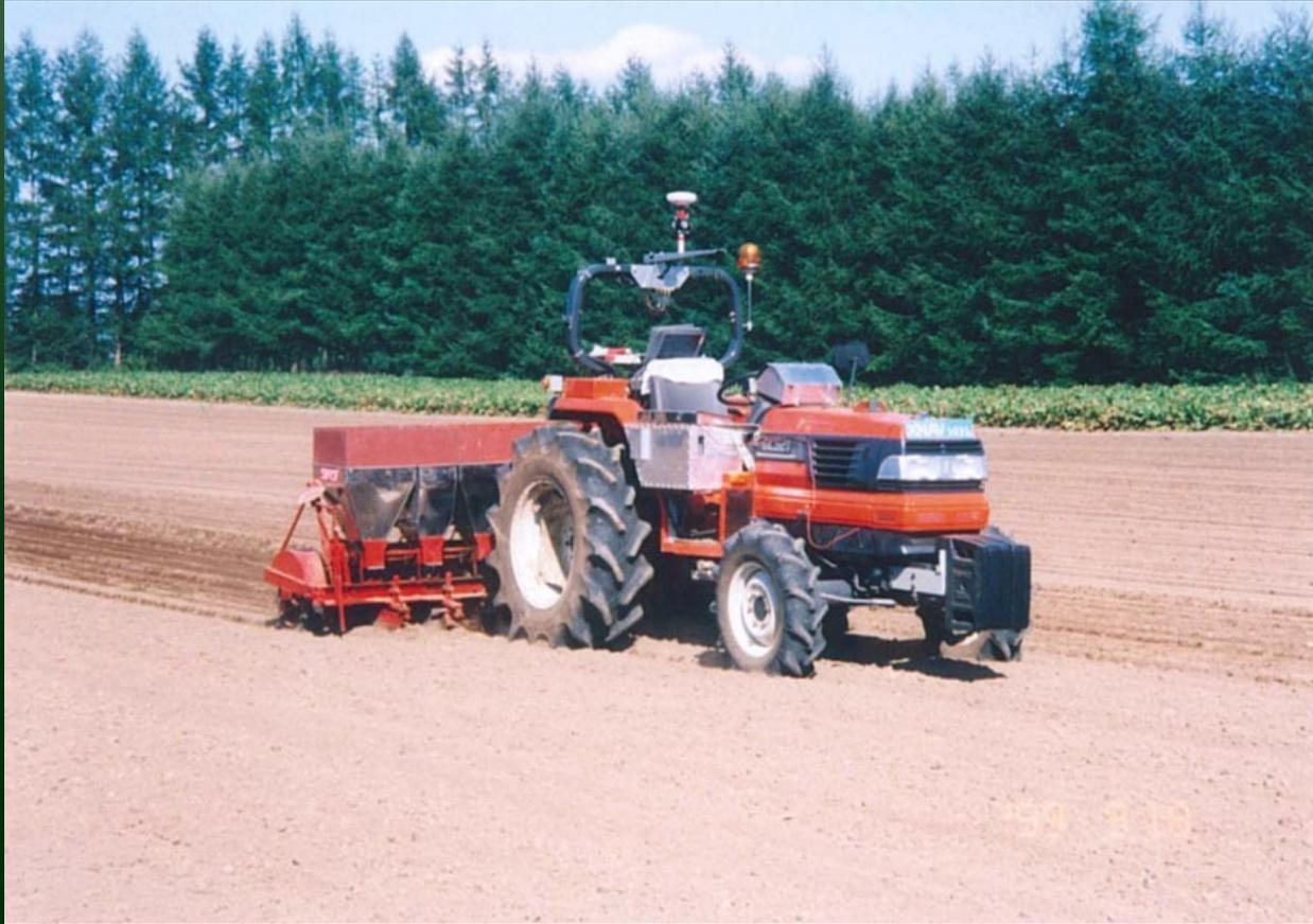
ロボット作業(ムギの播種作業)
