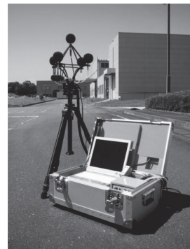
図1.2 低周波音の音源を 同定する音カメラ（画 像提供：熊谷組）
