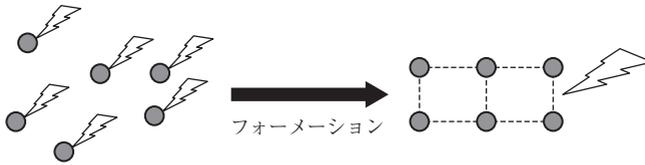
図 1.5 ビークルによるアンテナアレイの形成
