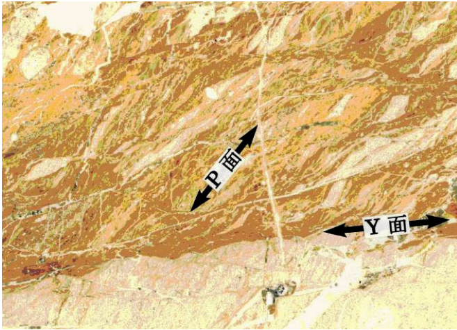
図 I-13 断層運動によって形成された面構造の例
